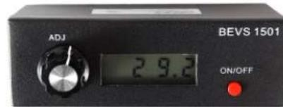
本儀器為 60° 光澤度計，根據 ISO-2813、ASTM-D2457、GB9754、GB9966、GB8807 標準製造。
